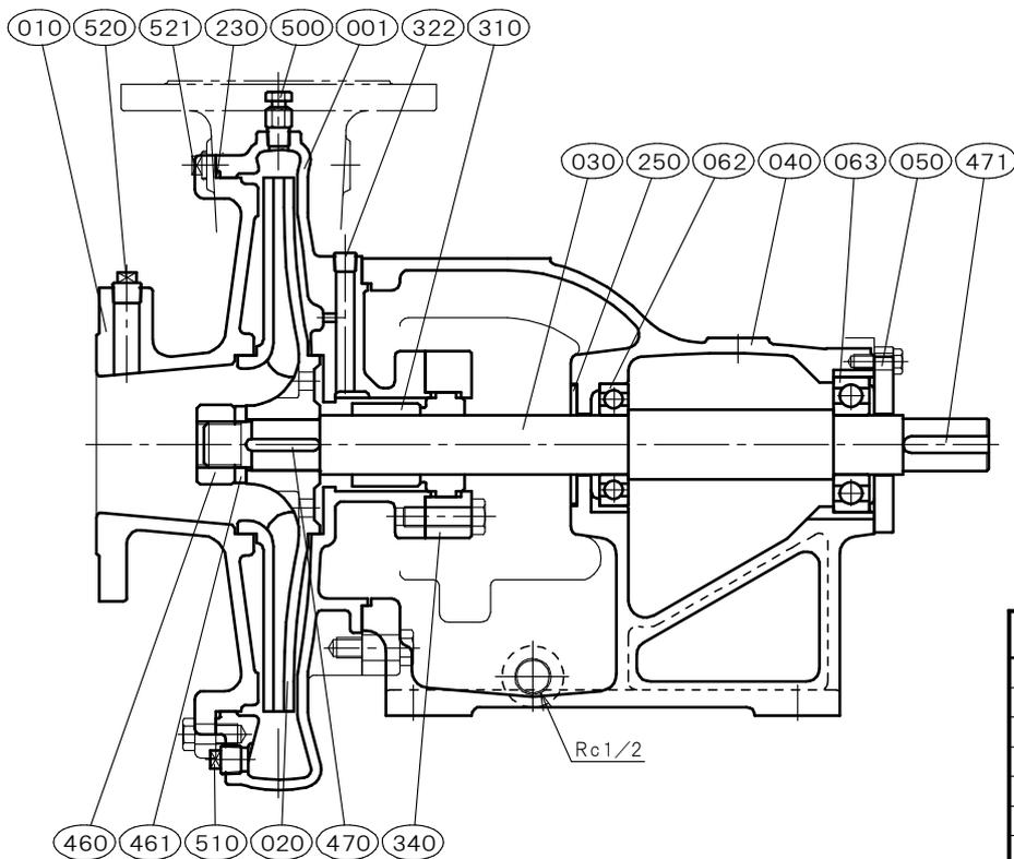
玉軸受は非接触形両シール付きを使用しております。但し玉軸受メーカーにより呼び名称が変わります。
